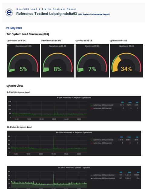
Eine weitere Funktion ist die Analyse der Log-Daten, welche durch die Provisionierung mittels SPML-Interface entstehen. *ndsLTA* extrahiert die Ergebnisse der ausgeführten Jobs und stellt diese nach Operation, Host, Error Code, User und Ausführungsdauer in verschiedenen Grafiken dar. Dies ermöglicht einen Überblick und das Erkennen von Unregelmäßigkeiten in Echtzeit, ohne in Log-Dateien oder die Provisionierungstools schauen zu müssen.
